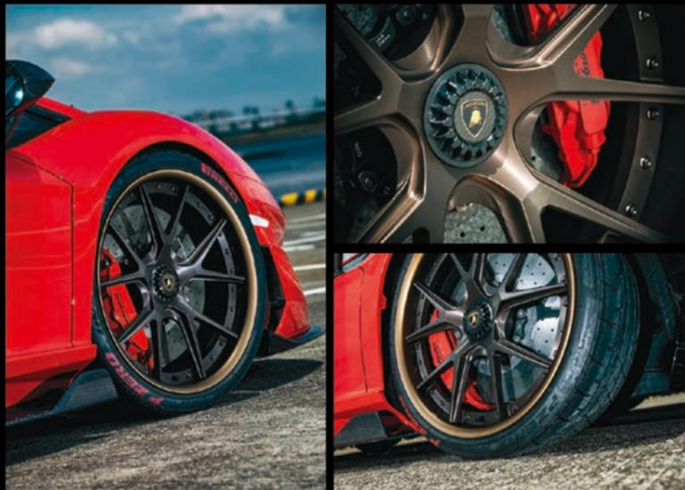
アヴェンタドールSVJ専用にマッチングさせたHF-LC5のセンターロック。フロント9.0J×20インチ、リヤ13.0J×21インチというのは純正ホイールと同サイズだ。255/30ZR20、355/25ZR21のピレリ・Pゼロコルサというタイヤも純正と同じ。ブラッシュド・アナダイズド・ブロンズの色味がロッソマーズのボディと調和している。
