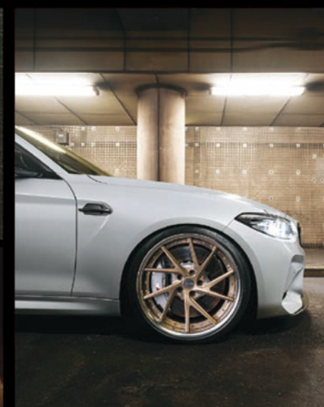
KWのクラブスポーツで調整した足まわりにハイパーフォージドHF-DiCが収まる。フロント9.5J、リヤ10.5Jの20インチ。ブラッシュド・ライトブロンズ・アナダイズドのディスクに、ハイポリッシュのリムという色味が硬派なM2コンペティションを華やかに彩る。
