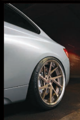
KWのクラブスポーツで調整した足まわりにハイパーフォージドHF-DiCが収まる。フロント9.5J、リヤ10.5Jの20インチ。ブラッシュド・ライトブロンズ・アナダイズドのディスクに、ハイポリッシュのリムという色味が硬派なM2コンペティションを華やかに彩る。
