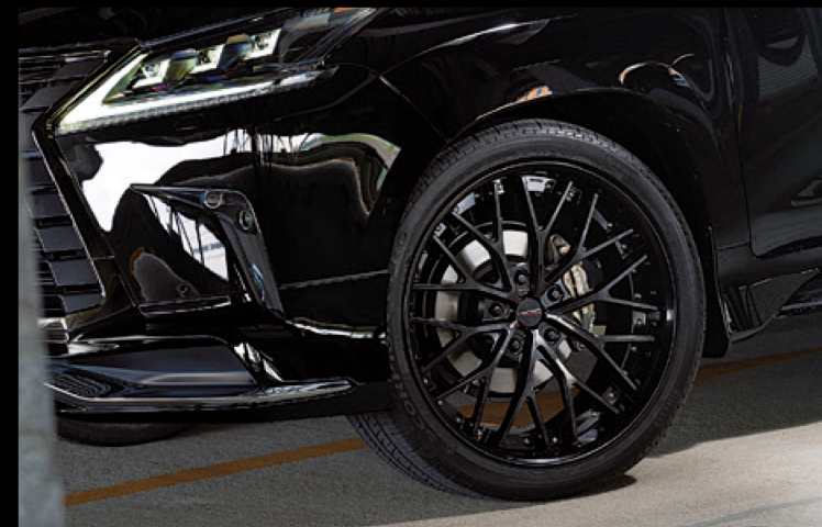
10本ツインスポークからなるメッシュパターンを持つHF-LMC。スーパースポーツ勢からSUVにまで似合う秀逸なデザインだ。強度的や剛性的にも理にかなっていて、P.C.Dの許容幅も大きいことから、このLX570に装着したような24インチまで存在する。タイヤサイズは305/35R24だった。
