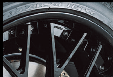
10本ツインスポークからなるメッシュパターンを持つHF-LMC。スーパースポーツ勢からSUVにまで似合う秀逸なデザインだ。強度的や剛性的にも理にかなっていて、P.C.Dの許容幅も大きいことから、このLX570に装着したような24インチまで存在する。タイヤサイズは305/35R24だった。
