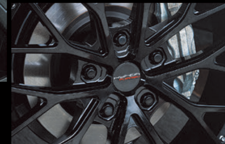
10本ツインスポークからなるメッシュパターンを持つHF-LMC。スーパースポーツ勢からSUVにまで似合う秀逸なデザインだ。強度的や剛性的にも理にかなっていて、P.C.Dの許容幅も大きいことから、このLX570に装着したような24インチまで存在する。タイヤサイズは305/35R24だった。
