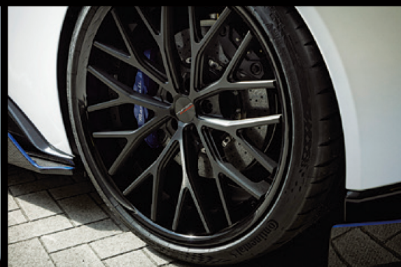
切削加工で鋭利に仕上げられたスポークは光の当たり方や見る角度によって毎回異なる表情を見せる。コンケーブデザインが全体に抑揚を与え、そこからリムエンドに向かってスポークが立体的に造形を描く。フロントはセミコンケーブ、リヤはディープコンケーブがセットされている。
