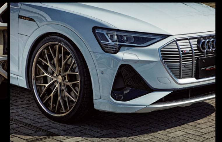
ピアスボルトが縁を彩り、大口径のリムは10本のスポークが力強く張り出す。その1本1本ををつぶさに眺めても丁寧なマシニング加工が施されている。鍛造切削の技術力の高さが伺い知れる。24インチの場合、P.C.D.は5-112~150まで対応。どのサイズもスポークがボルトホール間を通るように設計されている。マルチピースならではの細かなサイズ設定、色や質感の組み合わせを含めオーダーメイドの贅沢をぜひ味わってほしい。
