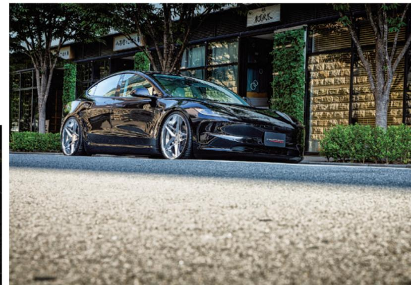
星型とも言われる2×5本スポークでディスク面を構築するESR。スポーク縦断面を上げながらセンターパートへと落とし込む凝った造形を持つ。これはフロント9.0J、リヤ11.0Jの21インチで、ともに立体感あふれるディープコンケープ。ディスクをミラーポリッシュ、アウターリムはハイポリッシュで強調させている。タイヤは245/30ZR21、295/25ZR21サイズのミシュラン・パイロットスポーツ4S。ショルダーの寝方が絶妙である。
