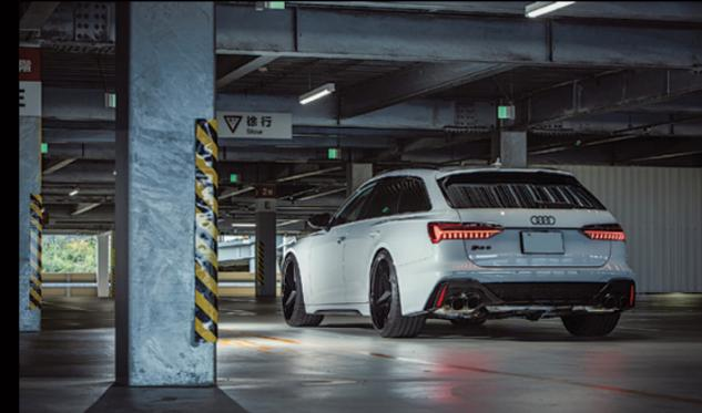
した。純正オプションで用意される22インチより0.5Jほど太い11.0Jに設定してわずかにタイヤを引っ張り、このローダウンしたボディにピッタリと一致させている。このマッチングを実現するため、CSFとハイパーフォードとが協力して実車を測定し、スプリングによるローダウン量と、そしてビレトリPZER OPZ4のショルダー形状までを研究したうえで、サイズを決めていったという。これこそ冒頭で触れたハイパーフォードによるオーダーメイドであり「徹底的にユーザーに寄り添う姿勢」である。
