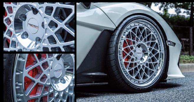
クラシカルへの原点回帰にとどまらず、各スポークを湾曲させながら交わらせるといった新鮮さも盛り込んだディスクデザインを持つ。高い設計開発能力と切削加工技術が融合して生まれた姿カタチだ。センターパットはすっきりとしたサークル形状で、あらゆるP.C.D.に対応する。今回は9.5J×21インチ、12.5J×22インチとなるが、EMRは20〜22インチ、24インチの範疇でサイズオーダーが可能となる。
