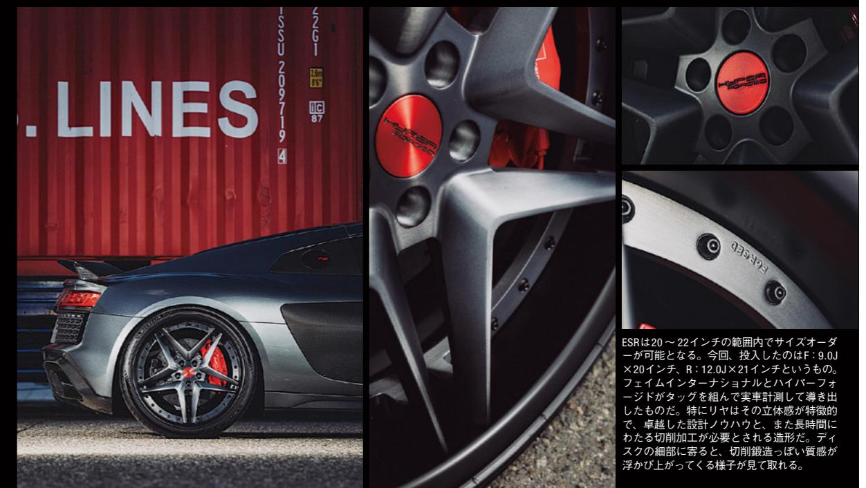
ESRは20~22インチの範囲内でサイズオーダーが可能となる。今回、投入したのはF:9.0J×20インチ、R:12.0J×21インチというもの。フェイムインターナショナルとハイパーフォージドがタッグを組んで実車計測して溝き出したものだ。特にリヤはその立体感が特徴的で、卓越した設計ノウハウと、また長時間にわたる切削加工が必要とされる造形だ。ディスクの細部に寄ると、切削鋸道っぽい質感が浮かび上がってくる様子が見て取れる。
