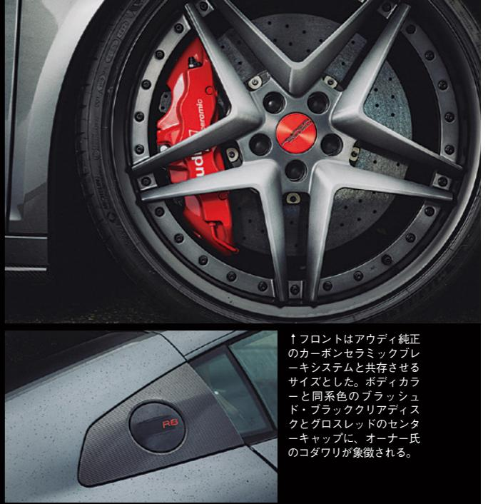
↑フロントはアウディ純正のカーボンセラミックブレーキシステムと共存させたオーナーと同系色のブラック・アダプティブラジカル・ブレーキとグロスレッドのセンターキャップに、オーナー氏のコダワリが象徴される。
