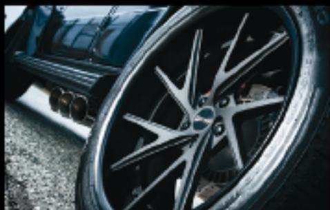
装着されるのは前後とも11.0J×22インチ。やみくもな太さを求めず305/40サイズのピレリ・スコルピオZEROと組み合わせる点が大きい。オンオフを問わないGクラスの方向性を活かした設計だ。
