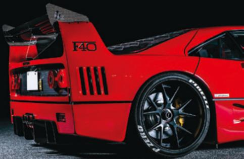
装着されるのはスーパースポーツ系に好評のHF-LCS5。ハイパーフォージドでは初の試みとなるセンターロックに改めた。ボルトホール周囲にはブランドロゴが入り、その文字はボディと同じ赤色に。ブレーキやフェンダーとのクリアランスが専用設計を物語る。
