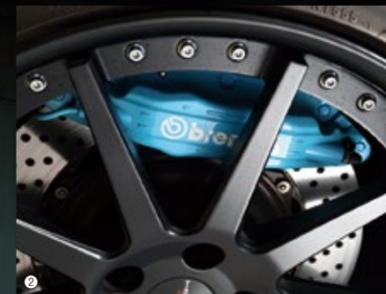
①こだわり抜いた足元はフロント9.0J、リア10.0JのハイパーフォードHF-C10をセレクト。リム幅に合わせてダンパーからインナーフェンダーまでを作り込み、通常では実現できないワイドリムを取めることに成功。もちろん通常走行も可能なセッティングが行なわれているのはMCCコンプリートだからのなせる技。②アクセントとして取り入れられるブレーキキットは、オリジナルのサムライブルーでペイントされるレンボの4ポット。ローターはφ355を組み合わせている。
