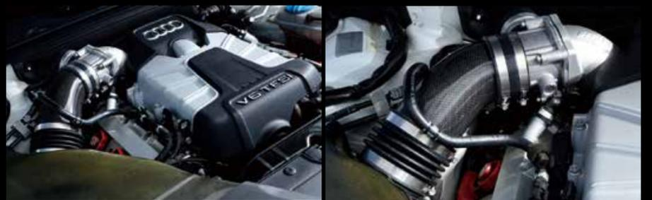
APRウルトラチャージャーはビッグスロットルによる効率的な燃調と、高効率化を実現するスーパーチャージャーのブリー交換、そしてECUプログラムの専用アップグレードをすることによって、これまでにないトルクとパワーを絞り出す夢のユニットだ。さらにクーリング対策として大容量インタークーラーを備えると、さらに強力なスベックを備えることになる。すべてのパーツをしっかり機能させるには、経緯とノウハウを有するAPRディーラーでのセッティングが基本となる。このクルマを製作したジェイファクトリーは、まさにそのトップランクのコンストラクターなのだ。
