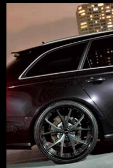
このスタイリングはハイパーフォージド HF-LC5 の 22×11.0 とアドバンスポーツ 295/25R22 の組み合わせで実現する。サスペンションは KW コイルオーバーバースプリングを組んだ。
