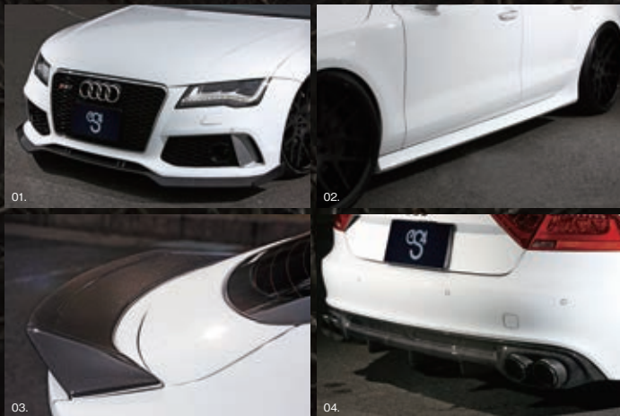
01. RS7純正バンパーのボトムには、オリジナルのリップスポイラーをインストール。センターを立ち上げ、両側を立たせた形状により、顔立ちをスポーティーに仕立てている。02. ステップ上部の贅肉をそぎ落とし、リアエンドで柔らかに立ち上げたRS純正サイドスポイラー。ボトムを斜めにカットし、一体感のあるサイドビューをつくる。03. ブラックアウトされたトランクスポイラーもRS7用のもの。04. 絞り込みの効いたRS7の純正リアバンパーと、カーボン生地が浮き上がるディフューザーを装着。流麗なシルエットを引き立てるボトムが、刺激的なリアスタイルを作り出す。テールエンドにはアクラボヴィッチのロゴが入ったカッターをプラス。
