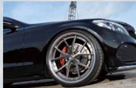
ハイパーフォーjordのLC5（F：20×9.0J R:20.0J×10.0J）。ブラッシュドブラッククリアグロスディスク/ガンメタアナライズドリムをセレクト。M4カラーに塗装したキャリバーとのクリアランスも必見。
