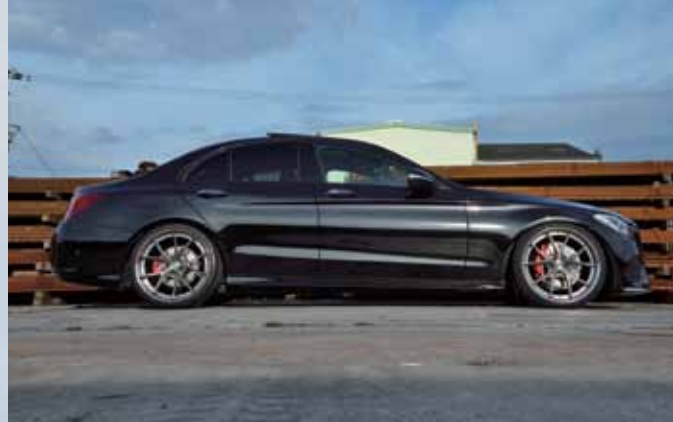
AMGラインに装備されたエアサスペンションをそのまま使用。コンフォートモードに対し、「Sport+」モードをセレクトにより-45mmロワードさせた状態。
